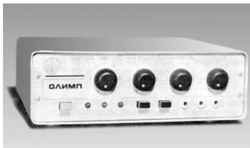
Рис. 5.10 - Аппарат «Олимп» для электродиагностики НМА НГК
